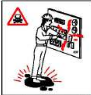
REPARACIÓN DE EQUIPOS BAJO TENSIÓN
