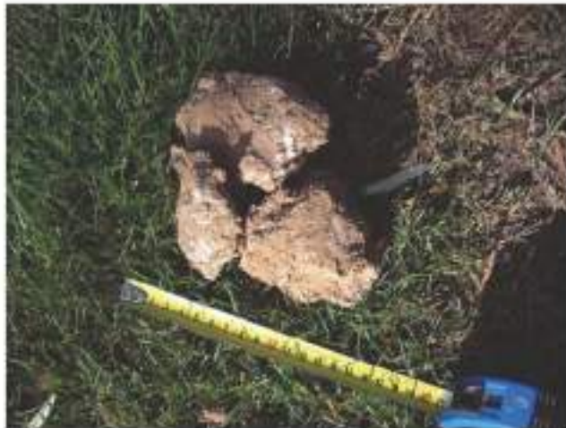
Fotografía 9. Arcillas limosas con algo de arena color ocre.
