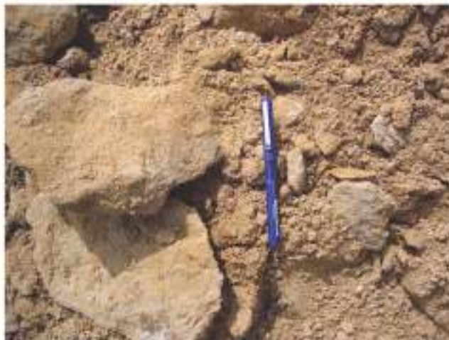
Fotografía 8. Detalle del nivel de arenas limosas arcósicas algo cementadas.
